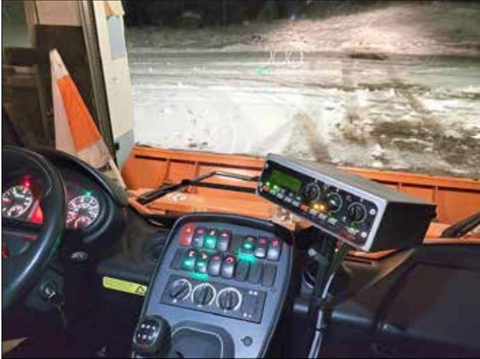
Im Multicar selbst sind allerhand Knöpfe und Schalter für das Schiebeschild, Allrad und den Streuaufsatz.
